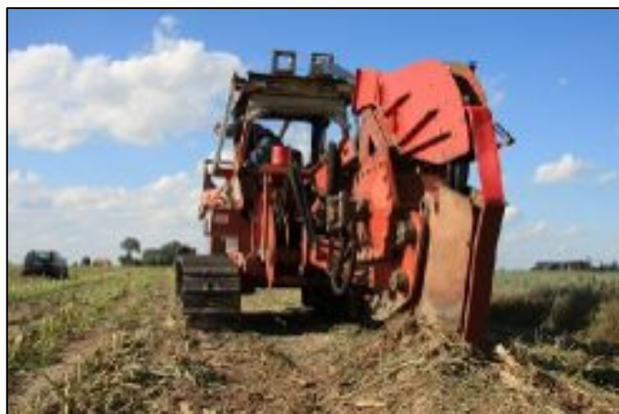
Rycina 13. Sprzęt wykorzystywany do układania kabli metodą plużenia (źródło: http://thomsen.pl )
