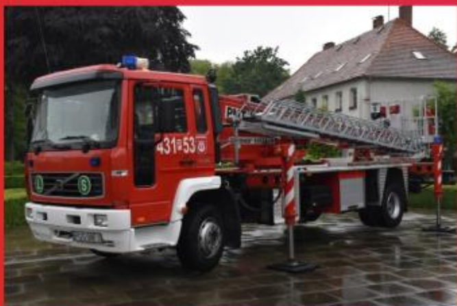
OSP Włoszakowice, podnośnik SHD-20 na podwoziu VOLVO FL26
